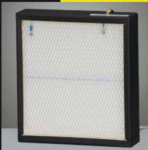
Los filtros panel minipleat IECEX son suministrados con cables de tierra integrados. Estos medios filtrantes plisados se ofrecen en armazones plásticos en todas las dimensiones habituales. Los medios filtrantes son de fibra de vidrio de alta calidad, colocados en húmedo y sellados en el armazón por una junta hermética fundida.
