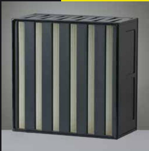
Las cajas de filtros de EMW® proporcionan áreas en la superficie de filtración extremadamente altas, que llegan hasta 40m<sup>2</sup>. Los medios filtrantes están unidos al armazón eléctricamente disipativo por una junta hermética fundida. La confiable unión de todo el perímetro previene fugas hasta los índices más altos de flujo. Además, las cajas filtrantes IECEx están disponibles con un sello in-situ de espuma continua ubicada en la entrada o salida de aire, según se desee.
