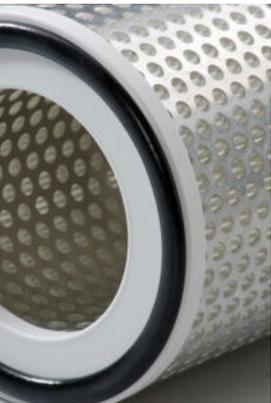
EMW®-Rundfilter sind in den ISO 16890 Filterklassen (ehemals EN 779) und E10-H14 gemäß EN 1822 erhältlich. Das Minipleat-Medium ist vollvergossen im Kunststoffrahmen eingesetzt. Eine nahtlose Endlos-Dichtung sorgt für eine leakagefreie Montage. Für zusätzliche Stabilität sorgt ein optional erhältliches Lochblech.
