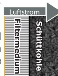
Eine 2-fache Filtration erzielen die Kombifilter von EMW®. Zunächst wird die Luft durch ein Filtermedium geleitet, welches in den Filterklassen M6-H14 erhältlich ist. Danach folgt die Adsorption über eine Schüttung an Aktivkohle.
