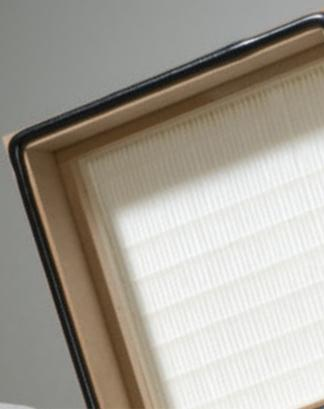
Luftfilter mit MDF-Rahmen bieten wir Ihnen in den Filterklassen gemäß ISO 16890 (ehemals EN 779) und E10-H14 gemäß EN 1822 in allen gängigen Abmessungen an.
