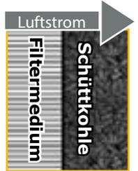
Eine 2-fache Filtration erzielen die Kombifilter von EMW®. Zunächst wird die Luft durch ein Filtermedium geleitet, welches in den Filterklassen M6-H14 erhältlich ist. Danach folgt die Adsorption über eine Schüttung an Aktivkohle.
