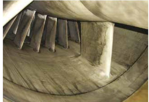
Kompressor-Fouling verhindert eine optimale Energieausbeute der Anlage und führt zu einem erhöhten Brennstoffbedarf sowie einhergehendem höheren CO<sub>2</sub>-Ausstoß.
