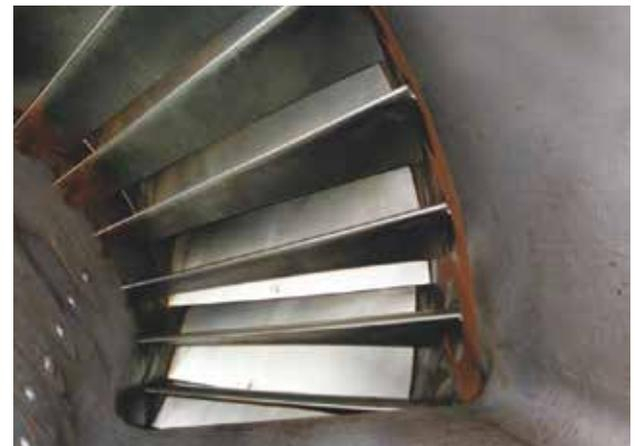
Luftfilter der Filterklasse (H)EPA verhindern Kompressor-Fouling effektiv. So erfolgte im Beispiel oben, mit Einsatz von EMW® (H)EPA-Filtern der Filterklasse E12, selbst nach 48.000 Betriebsstunden weder eine On- noch Offline-Wäsche.
