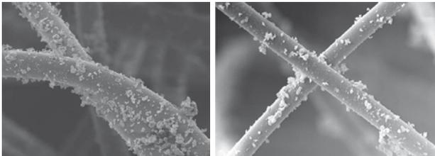
Kleinstpartikel sind vorrangig verantwortlich für Kompressor-Fouling. Durch gängige Vorfilterklassen lassen sich diese Partikelgrößen jedoch nicht effektiv abscheiden.
