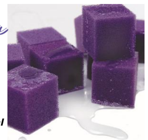
Poret®aqua nach zweijährigem Einsatz in einem aus Beton gefertigten Bioreaktor.
