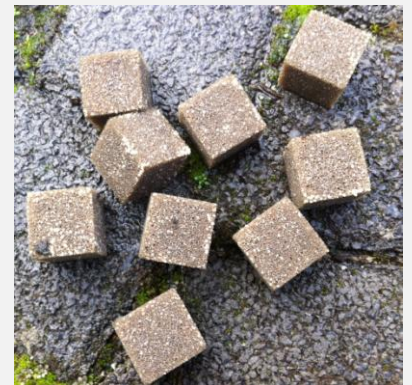
Poret®aqua nach zweijährigem Einsatz in einem aus Beton gefertigten Bioreaktor.
