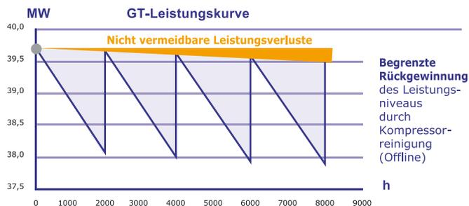
Leistungsverluste lassen sich auch ohne Kompressor-Reinigung reduzieren. Und zwar dauerhaft durch effiziente Filtration der Zuluft.
