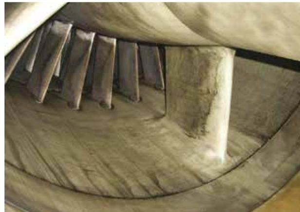
Kompressor-Fouling verhindert eine optimale Energieausbeute der Anlage und führt zu einem erhöhten Brennstoffbedarf sowie einhergehendem höheren CO<sub>2</sub>-Ausstoß.
