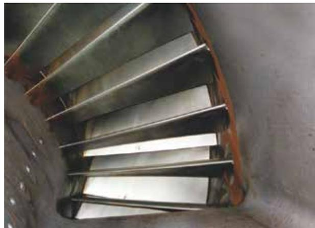
Luftfilter der Filterklasse (H)EPA verhindern Kompressor-Fouling effektiv. So erfolgte im Beispiel oben, mit Einsatz von EMW® (H)EPA-Filtern der Filterklasse E12, selbst nach 48.000 Betriebsstunden weder eine On- noch Offline-Wäsche.
