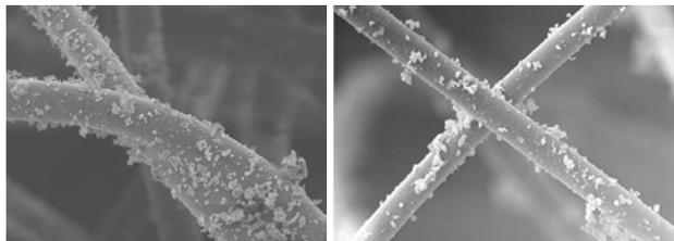
Kleinstpartikel sind vorrangig verantwortlich für Kompressor-Fouling. Durch gängige Vorfilterklassen lassen sich diese Partikelgrößen jedoch nicht effektiv abscheiden.
