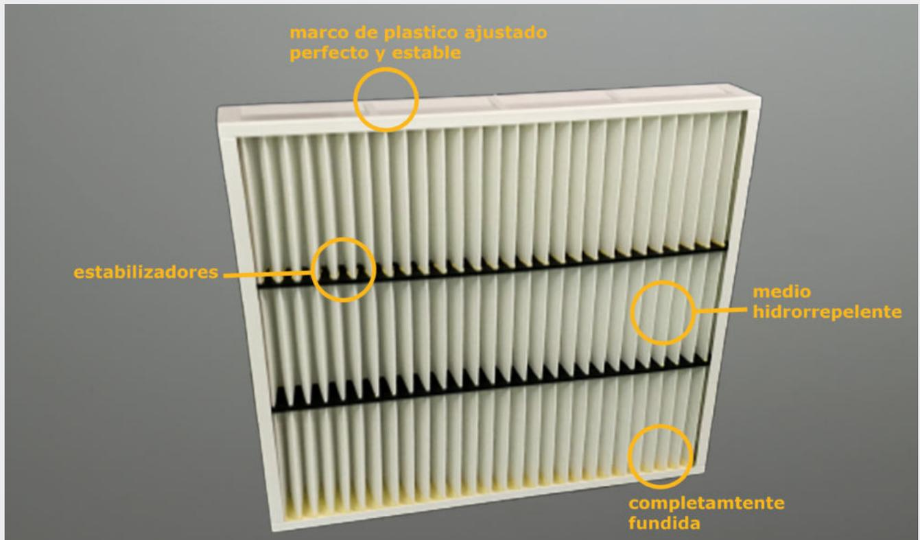
El Z-Line GT LM6000 tiene un marco de plástico que se adapta perfectamente al diseño especial de las casas de filtros LM6000. Además, este prefiltro LM6000 permanece estable incluso después de un largo periodo de uso gracias al marco totalmente encapsulado y a los estabilizadores integrados. Esto garantiza que el aire de suministro pase a través del medio sintético repelente al agua completamente libre de fugas.
