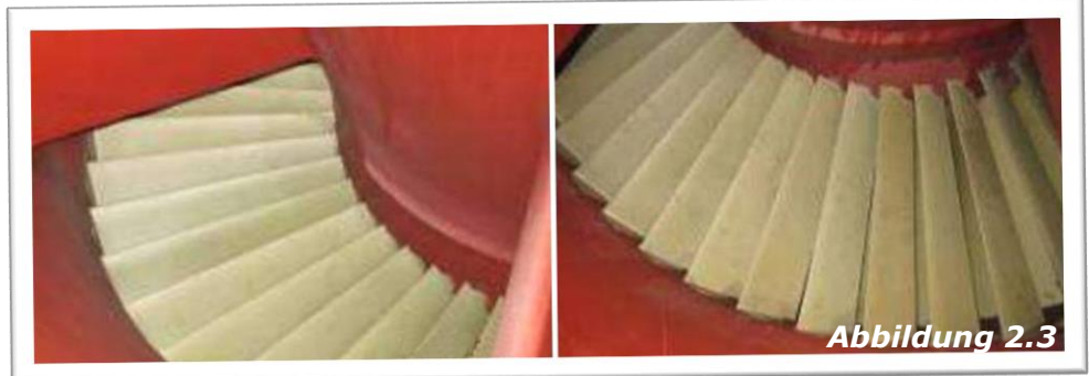
Nach dem EMW® Upgrade ist von Kompressor-Fouling kaum mehr eine Spur. Seit 2012 werden die Anlagen ohne On-/Offline Washing betrieben.
