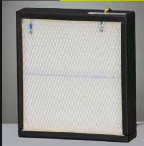
Eine Erdungsfahne ist beim IECEX Minipleat Panelfilter bereits montiert. Die plissierten Filtermedien werden in Kunststoffrahmen in allen gängigen Abmessungen angeboten. Als Medium kommen hochqualitative Glasfasermedien zum Einsatz. Diese werden im Rahmen leckagefrei vergossen.
