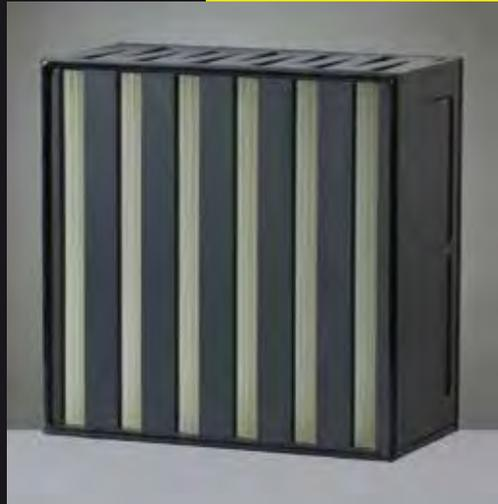
EMW®-Filterboxen bieten ein Maximum an Filterfläche mit bis zu 40m<sup>2</sup>. Das Filtermedium ist fest und gleichmäßig im ableitfähigen Kunststoffrahmen integriert, sodass selbst bei starker Belastung keine Leckagen entstehen können. Für eine rundum leckagefreie Installation sind die Filterboxen zusätzlich mit einer Endlos-Dichtung erhältlich, welche wahlweise auf der Rein- oder Rohluftseite angebracht wird.
