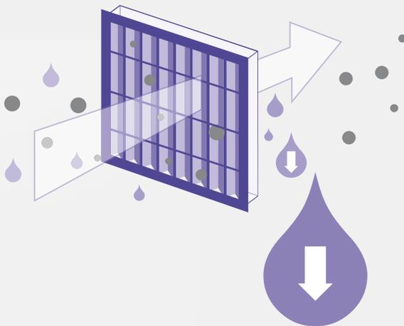
Gelangen Tropfen in den Bereich der Vor- und Endfilter, verursacht dies einen Anstieg der Gesamtdruckdifferenz. Hauptgrund ist ein Aufquellen der bereits abgeschiedenen Partikel in den Filterelementen. Einhergehend ist eine verkürzte Einsatzzeit der Luftfilter. Die Lösung? EMW®-Koaleszer, welche den Eintritt von Wassertropfen effektiv verhindern!
