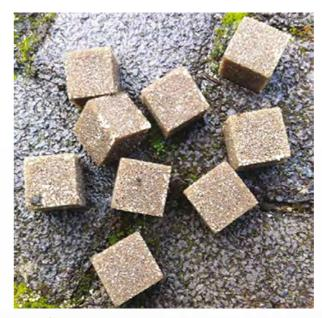
**PORET**<sup>®</sup>**aqua** nach zweijährigem Einsatz in einem aus Beton gefertigten Bioreaktor. Weder Abrasion noch ein Verblocken des Trägermaterials ist feststellbar.
