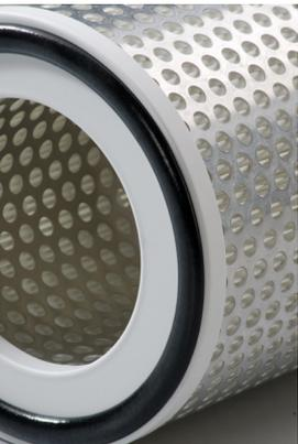
EMW®-Rundfilter sind in den Filterklassen M6-F9 gemäß EN 779 und E10-H14 gemäß EN 1822 erhältlich. Das Minipleat-Medium ist vollvergossen im Kunststoffrahmen eingesetzt. Eine nahtlose Endlos-Dichtung sorgt für eine leakagefreie Montage. Für zusätzliche Stabilität sorgt ein optional erhältliches Lochblech.
